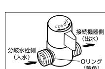
(注意: Oリング(黄色)側のネジが分岐水栓側と接続されているか確認してください。)
