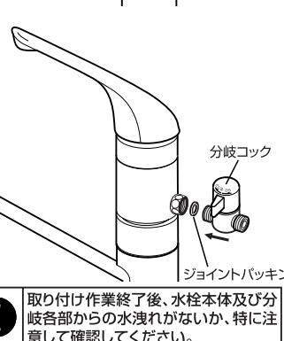
●分岐コックの開閉操作(ひらく・とじる)をして締め付けた部分がゆるまないか確認してください。
