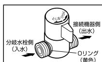
(注意: Oリング(黄色)側のネジが分岐水栓側と接続されているか確認してください。)
