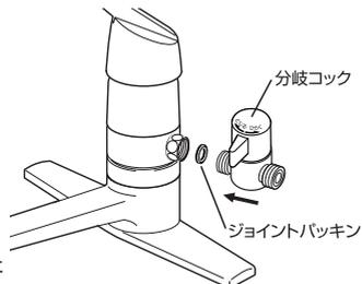
分岐コックの開閉操作(ひらく・とじる)をして締め付けた部分がゆるまないか確認してください。
