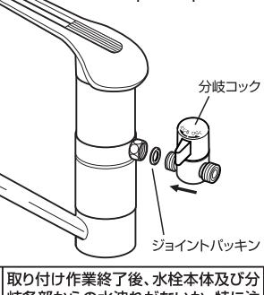
1 取り付け作業終了後、水栓本体及び分岐各部からの水漏れないか、特に注意して確認してください。
