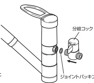
**!** 分岐コックの開閉操作(ひらく・とじる)をして締め付けた部分がゆるまないか確認してください。
