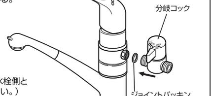
分岐コックの開閉操作(ひらく・とじる)をして締め付けた部分がゆるまないか確認してください。
