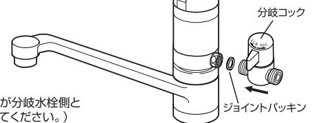
**!** 分岐コックの開閉操作(ひらく・とじる)をして締め付けた部分がゆるまないか確認してください。
