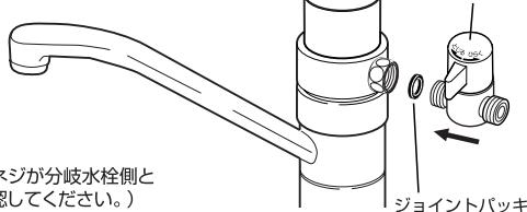
● 分岐コックの開閉操作(ひらく・とじる)をして締め付けた部分がゆるまないか確認してください。
