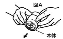
5-2: シングル分岐のピン(凸)を後方にして、水栓金具本体のピン穴(凹)とが合うようにピンをはめ込む。
