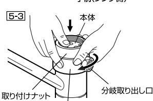
(注意1:シングル分岐を水栓本体に取り付ける時、ゆっくりとはめ込みをしてください。シングル分岐本体やハブに取り付けられているパッキンが損傷し、水洩れする恐れがあります。)
