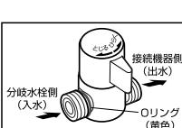
(注意: Oリング(黄色)側のネジが分岐水栓側と接続されているか確認してください。)
