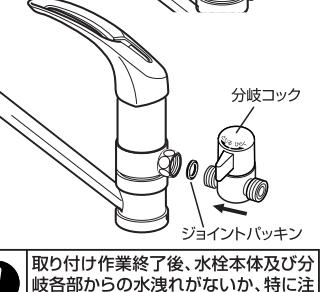
**!** 取り付け作業終了後、水栓本体及び分岐各部からの水漏れがないか、特に注意して確認してください。
