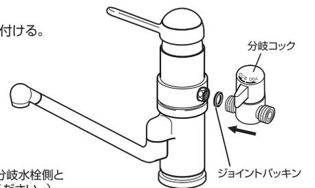
❗ 分岐コックの開閉操作(ひらく・とじる)をして締め付けた部分がゆるまないか確認してください。
