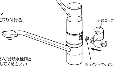
1 分岐コックの開閉操作(ひらく・とじる)をして締め付けた部分がゆるまないか確認してください。
