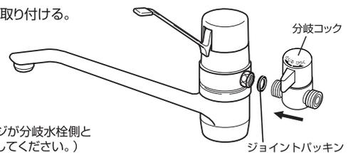
❗ 分岐コックの開閉操作(ひらく・とじる)をして締め付けた部分がかぶるまじりか確認してください。
