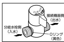
(注意:オーリング(黄色)側のネジが分岐水栓側と接続されているか確認してください。)
