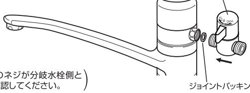
! 取り付け作業終了後、水栓本体及び分岐各部からの水漏れないか、特に注意して確認してください。
