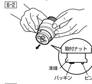
❗ シングル分岐の本体を押し出す際に、ハブより抜け落ちる場合がございます。厚めのタオル、もしくは厚めのゴム板の上で行っていただき、転げ落ちない場所で作業を行ってください。キッチン・床・シングル分岐の破損または足の上などに落ちますと大きなケガに繋がる恐れもございます。
