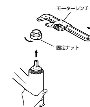
お知らせ: 固定ナットを取り外す際に吐水口と水栓金具本体の間に取り付いているスリップリング(樹脂製の黒い部分)が外れる場合がございます。元に戻してください。スリップリングには向きがございます(図4)を参照ください。
