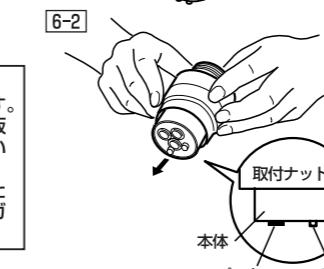
! シングル分岐の本体を押し出す際に、ハブより抜け落ちる場合がございます。厚めのタオル、もしくは厚めのゴム板の上で行っていただき、転げ落ちない場所で作業を行ってください。キッチン・床・シンク分岐の破損または足の上などに落ちますと大きなケガに繋がる恐れもございます。
