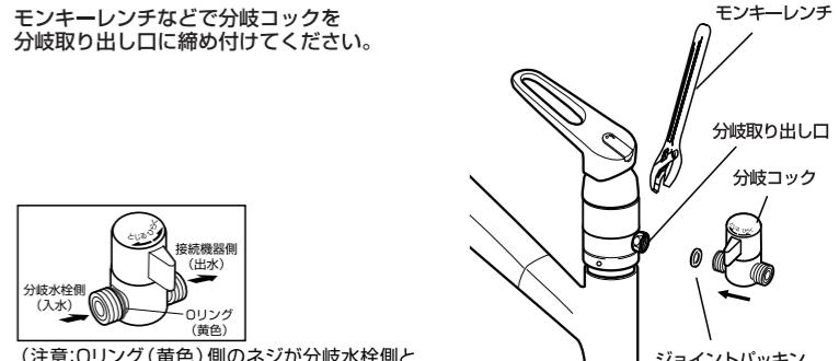
! 分岐コックの開閉操作(ひらく・とじる)をして締め付けた部分がゆるまないか確認してください。
