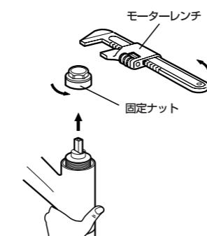
お知らせ: 固定ナットを取り外す際に吐水口と水栓金具本体の間に取り付いているスリップリング(樹脂製の黒い部分)が外れる場合がございます。元に戻してください。スリッピングには向きがございます(図4)を参照ください。
