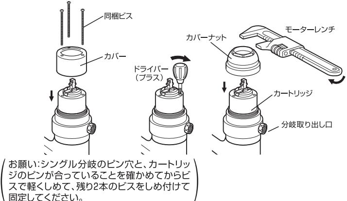
(お願い:シングル分岐のピン穴と、カートリッジのピンが合っていることを確かめてからビスで軽くしめて、残り2本のビスをしめ付けて固定してください。)
