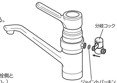
**!** 分岐コックの開閉操作(ひらく・とじる)をして締め付けた部分がゆるまないか確認してください。
