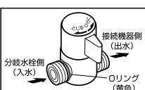
(注意:オリング(黄色)側のネジが分岐水栓側と接続されているか確認してください。)
