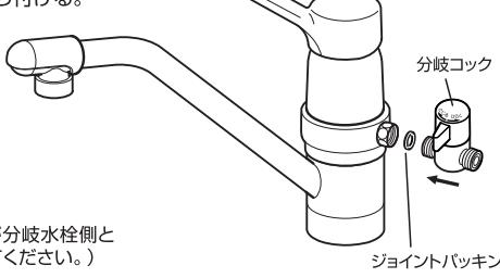
**!** 分岐コックの開閉操作(ひらく・とじる)をして締め付けた部分がゆるまないか確認してください。
