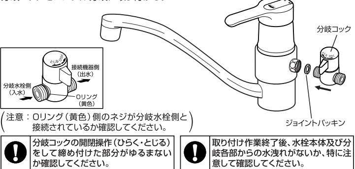
(注意:Oリング(黄色)側のネジが分岐水栓側と接続されているか確認してください。)
