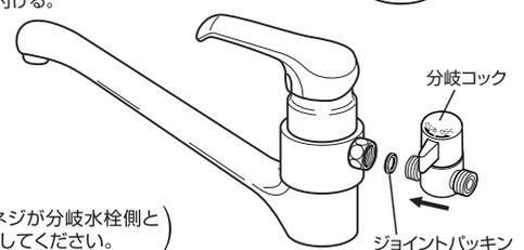
! 分岐コックの開閉操作(ひらく・とじる)をして締め付けた部分がゆるまないか確認してください。
